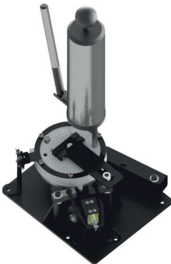
Рисунок 12.3.3 – Доливка демпферной жидкости.
