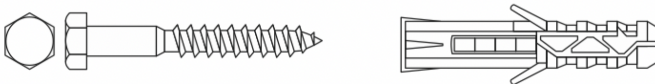
Рисунок 7.4.1 – Шуруп с шестигранной головкой «Глухарь» с дюбелем.
